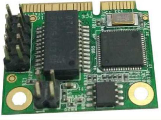
千兆网卡采用半高规格的 Mini PCIE 插槽转 RJ45 千兆以太网接口，集成英特尔 I211AT 芯片。与连接 4 组双绞铜网线最大传输率可达千兆，距离最大达 100 米远。它是 100% 完全向后兼容 10 / 100Mbps 系统。可以在现有的任何网络上使用。
